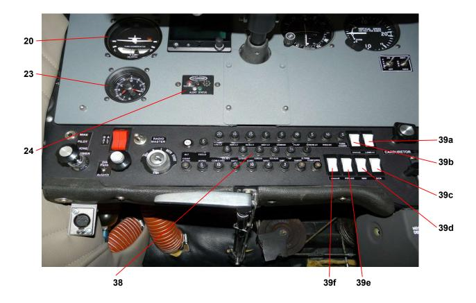
20 Wendezeiger 39 **Schalter** Boarduhr Landescheinwerfer 23 39a 24 CO-Alarm - CoGUARDIAN-492 39b keine Funktion 38 Sicherungen 39c Beacon Navigationslichter Staurohrheizung 39d 39e keine Funktion 39f
